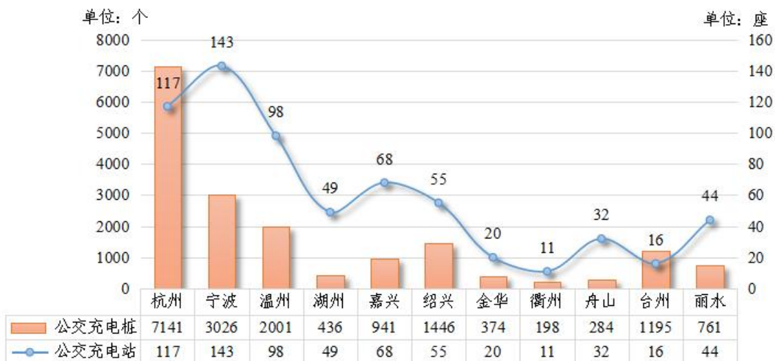
图 2-8 2022 年浙江省各地市公交专用充电设施建设情况
